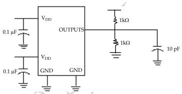
For parameter t<sub>8</sub> (output slew rate)
