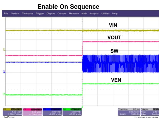
V<sub>IN</sub>=1.8V, V<sub>OUT</sub>=2.8V, I<sub>OUT</sub>=10mA, EN=0 to 5V
