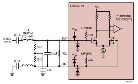
Figure 11. Transformer Driven ENC+/ENC<sup>-</sup>
