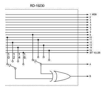
FIGURE 21. INCREMENTAL ENCODER EMULATION RESOLUTION CONTROL
