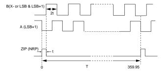
FIGURE 22. INCREMENTAL ENCODER EMULATION
