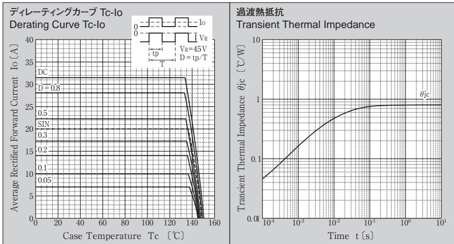
\* Sine waveは50Hzで測定しています。
