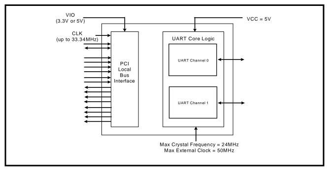
FIGURE 3. TYPICAL APPLICATION FOR A UNIVERSAL ADD-IN CARD
