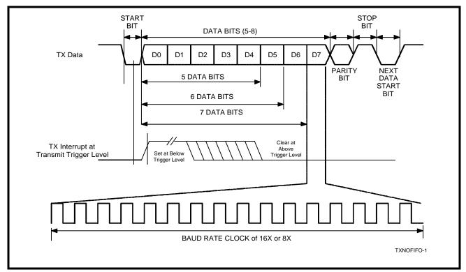
FIGURE 24. TRANSMIT DATA INTERRUPT AT TRIGGER LEVEL
