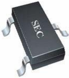
3 pin SOT23 (suffix SO)
