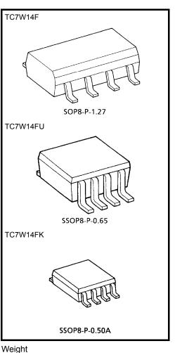
Weight SOP8-P-1.27: 0.05 g (typ.) SSOP8-P-0.65: 0.02 g (typ.) SSOP8-P-0.50A: 0.01 g (typ.)
