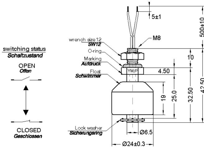
Abmessungen / dimensions (mm)
