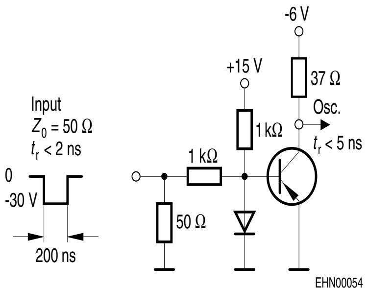
Oscillograph:  $R > 100\Omega$ ,  $C < 12\text{pF}$ ,  $t_r < 5\text{ns}$
