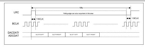
Figure 52 TDM in DSP Mode B
