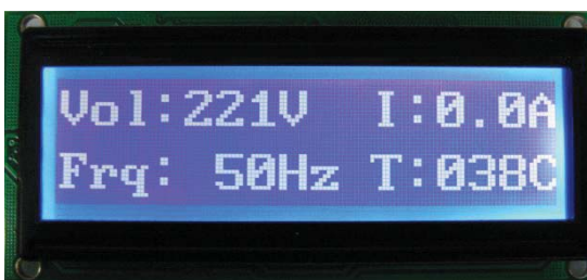
图 8.8c EG8010 连接 12832 工作时液晶屏显示信息
