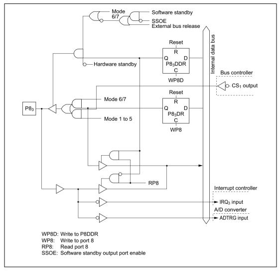
Figure C.8 (d) Port 8 Block Diagram (Pin P83)
