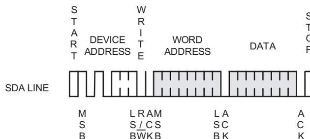
Figure 9. Byte Write
