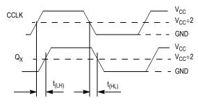
$t_{SK(P)}$  = |  $t_{PLH} - t_{PHL}$  |
