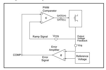
Figure 1: V<sup>2TM</sup> Control Diagram.
