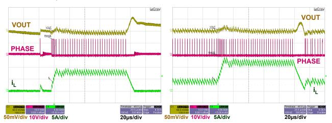
Figure 14: Load Transient 0-8A
