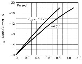
$\rm V_{\rm DS}$  - Drain to Source Voltage - V
