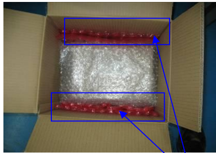
图 5(在长方向的侧边各放一块对折好的气泡垫以填充箱中空隙)
