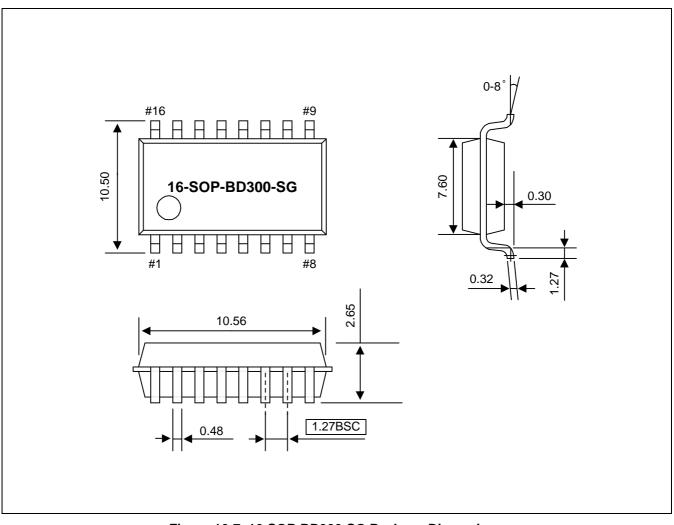
Figure 16-7. 16-SOP-BD300-SG Package Dimensions
