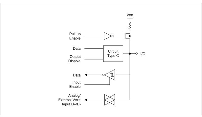
Figure 1-8. Pin Circuit Type CP
