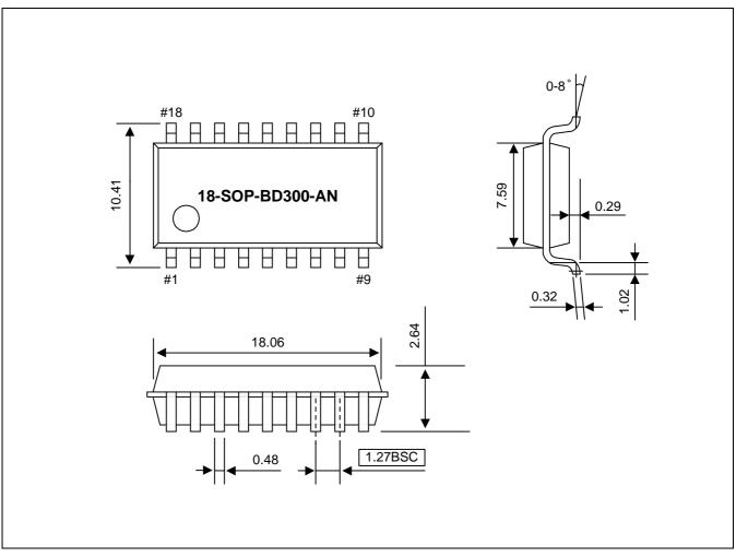
Figure 16-5. 18-SOP-BD300-AN Package Dimensions
