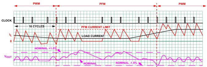
FIGURE 54. SKIP MODE OPERATION WAVEFORMS
