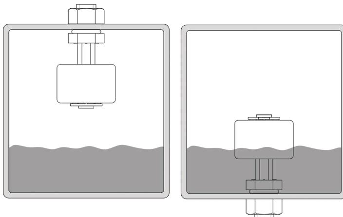
Bei Montage mit aufwärts gerichtetem Steigrohr kehrt sich das Schaltverhalten um.
