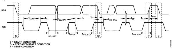
$\textit{Figure 3. } 1^2 \textit{C-Compatible Interface Timing Diagram}$
