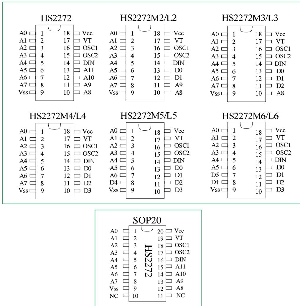
如上图所示：2272 的所有型号均能封装成 DIP18 和 SOP20 两种形式，只是 SOP20 多了 10 和 11 两个管脚，如无特殊说明，下面均为 DIP18 做说明。
