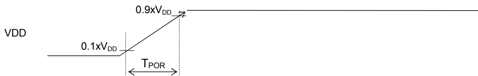
Power-on reset activation power rise time (T POR )
