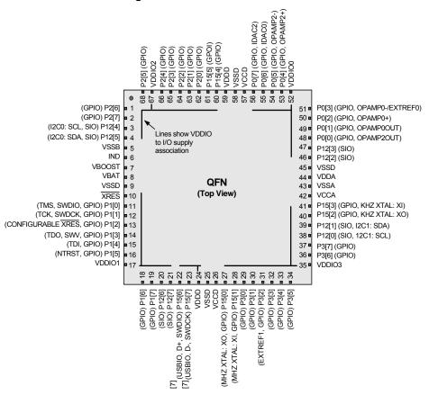
Figure 2-5. 68-Pin QFN Part Pinout<sup>[8]</sup>
