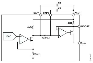
Figure 45. Iout Filter Circuitry
