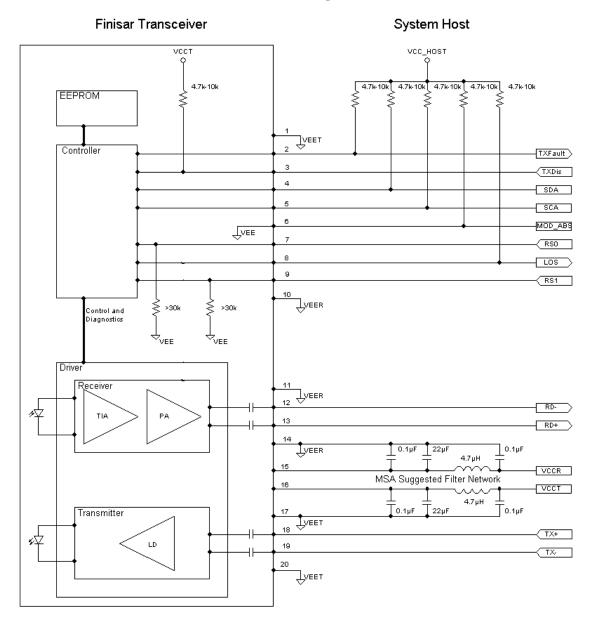
Figure 5. Host-Module Interface
