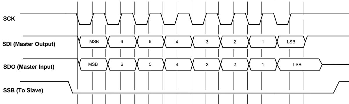
Figure 31. SPI Interface
