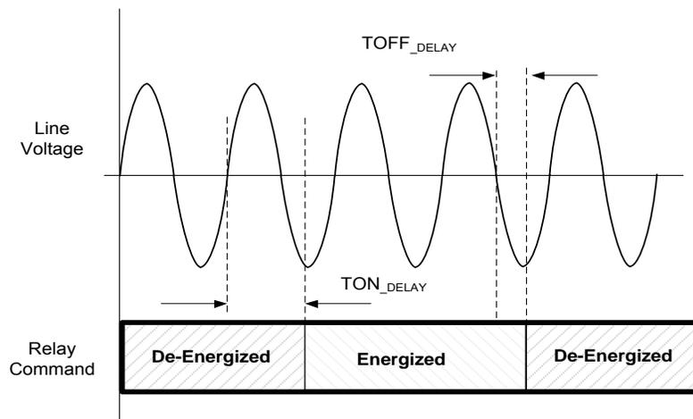
Figure 26. Relay Timing
