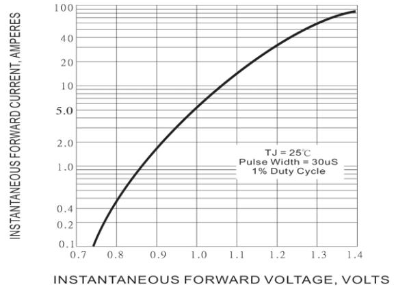
Fig. 2 - TYPICAL INSTANTANEOUS FORWARD CHARACTERISTICS PER ELEMENT
