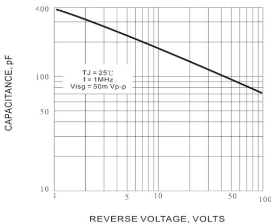
Fig. 5 - TYPICAL JUNCTION CAPACITANCE PER ELEMENT
