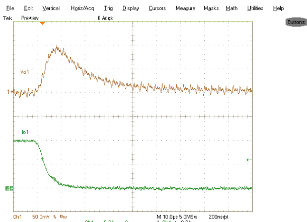
Fig.23: Load Transient 10-0A. Ch 1 : V_{o1}(2V5) , Ch 4 : I_{o1}
