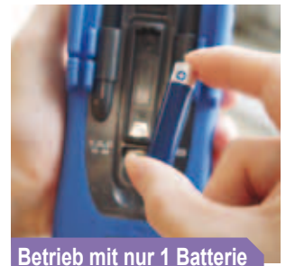
Betrieb mit nur 1 Batterie
