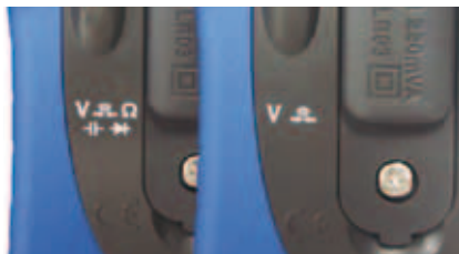
kein A-Anschluss für höhere Sicherheit
