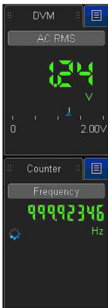
그림 26: DVM 및 카운터는 별도의 신호 경로를 활용하여 기존과 같이 오실로스코프 프로브를 이용해 트리거 없이 측정을 수행할 수 있도록 지원합니다.
