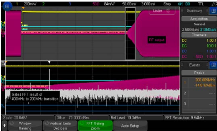
그림 21c: 200 MHz에서 RF 신호를 관찰하기 시작합니다. RF 아날로그 파형에서도 이를 검증할 수 있습니다.
