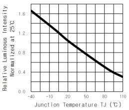
Fig. 7 RELATIVE LUMINOUS INTENSITY V.S.JUNCTION TEMPERATURE
