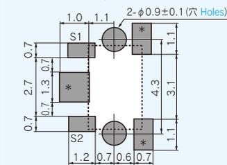
\* 金属ケースダミーパターン Metal case dummy pattern
