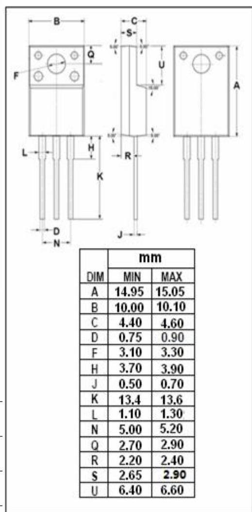
**Isc N-Channel MOSFET Transistor****STP30NF10FP****ELECTRICAL CHARACTERISTICS** $T_c=25^\circ\text{C}$  unless otherwise specified
